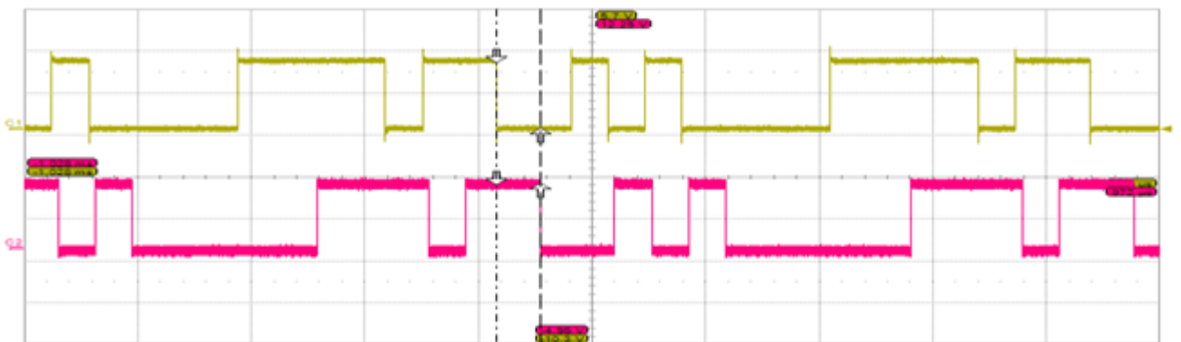
Fig. 7 Măsurări ale semnalului inițial QPSK și secvența binară obținută după demodulare
