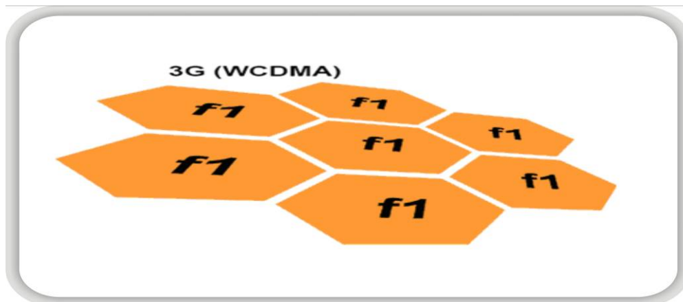
Figura 2.2. Zona de reutilizare în tehnologie WCDMA
