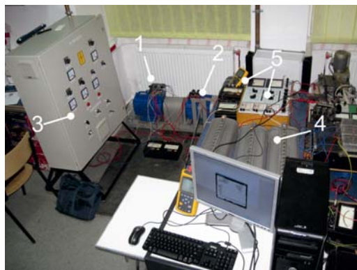
Fig.2.3.7. Stand experimental pentru agregate aeroelectrice cu generator DSWIG [PRO-2012], unde: (1) motor de inducție pentru antrenare ; (2) generator DSWIG; (3) convertor electronic de putere cu tensiune și frecvență variabilă pentru alimentarea motorului de inducție; (4) sarcina rezistivă ; (5) aparate de măsură.
