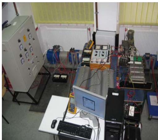
Fig.4.3.1. Stand de testare experimentală pentru generatoare de energie din surse regenerabile cu viteză variabilă (respectiv DSWIG, PMSG) realizat la Universitatea Politehnica Timișoara.
