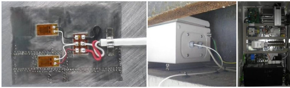
Fig. 9. Senzor, cutie de jonctiune și sistem de achiziție de date
