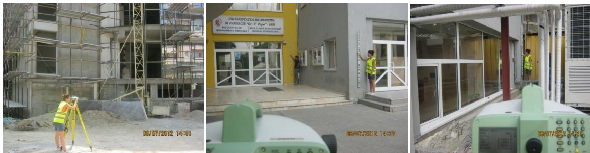
Fig.16. Observații efectuate prin metoda nivelmentului geometric
